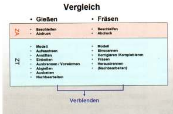
Abb. 2: Vergleich im Arbeitsablauf zwischen Gieß- und Frästechnik (ZA – Zahnarzt; ZT – Zahntechniker)
