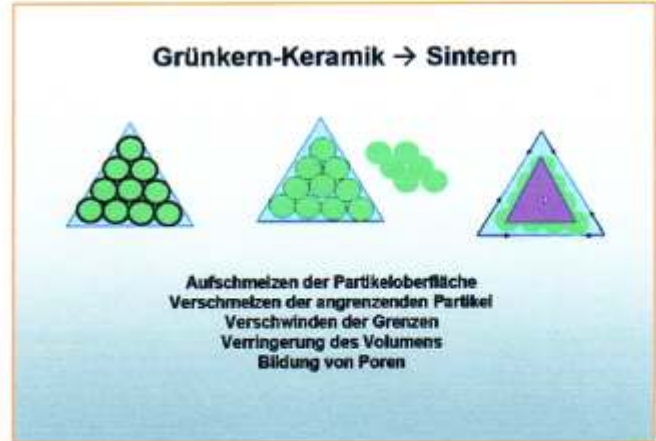
Abb. 2 Schematische Darstellung des Sinterprozesses.
