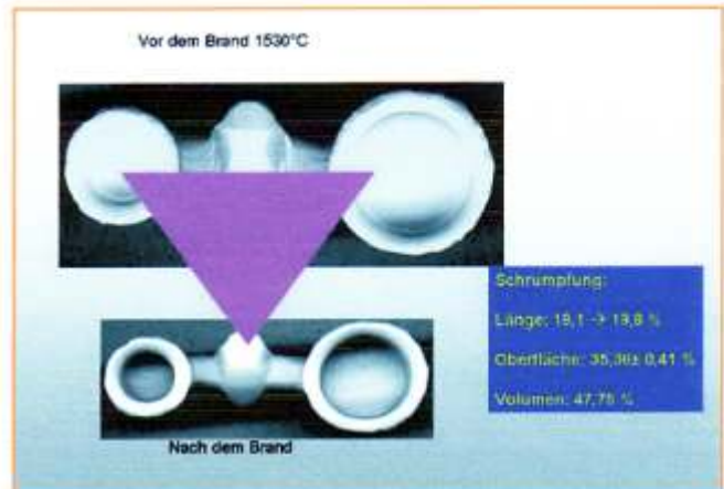
Abb. 4 Darstellung der Dimensionsänderungen durch den Sinterprozess am Beispiel einer 3-gliedrigen Brücke, oben vor und unten nach dem Sinterprozess.
