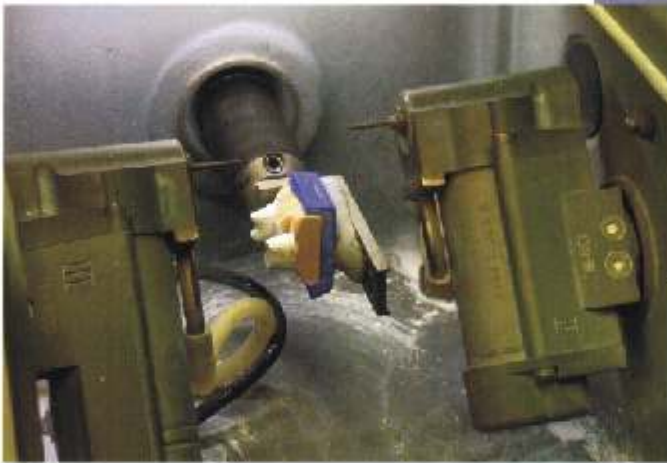
Abb. 3 und 4 Das präparierte Modellsegment wird nun auf dem Objektträger befestigt und im inLab CAD-Gerät eingespannt.
