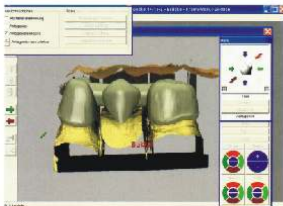
Abb. 9 ... und kontrollieren am Bildschirm die Platzverhältnisse für die spätere Verblendung.
