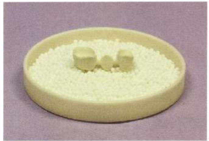
Abb. 15 Der eingefärbte Rohling wird auf dem speziellen Brennträger des Sinterofens platziert.
