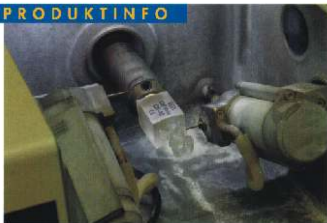
Abb. 17 Bei Vita CAD-Waxx handelt es sich um formstabile Fräsblöcke für die CAD/CAM-Technik. Sie bestehen aus PMMA-Kunststoffmaterial, das rückstandsfrei verbrennt.
