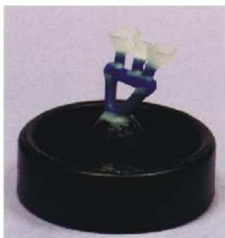
Abb. 20 Nach dem Verschleifen der Trennstelle wird das gefräste Kunststoffgerüst angestiftet.
