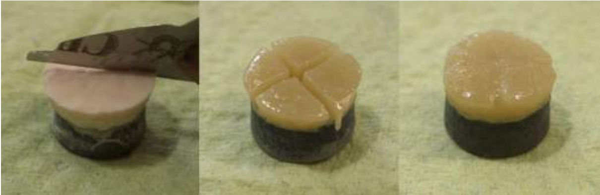
Abb. 9: von links: Separierung der Keramik; Zustand nach dem I. Brand und II. Brand
